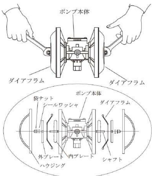
ポンプ本体内部の分解は、左右の袋ナットにスパナーをかけ一方を固定して回し袋ナットを外します。シャフトに固定された部品はプレートナット、ダイアフラムの順にとれて左図の様に開けます。この時、シャフトにパイプレンチ等はかけないで下さい。尚、左右のダイアフラムの向きは凹みがある方がポンプ本体側になります。プレートは内、外とありますが、いずれもR面がダイアフラムにあたります。
